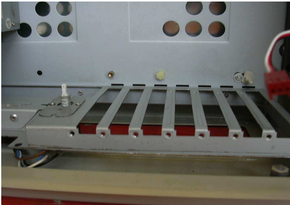
Η βάση στήριξης για τις PCI κάρτες
