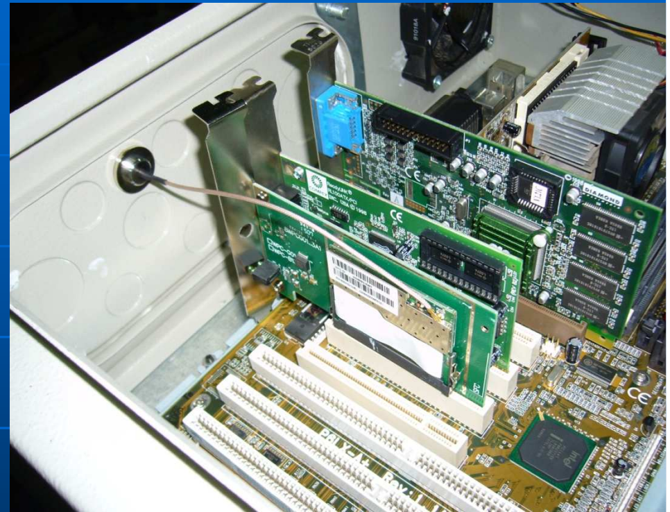
Τοποθέτηση ασύρματης κάρτας και pigtail
