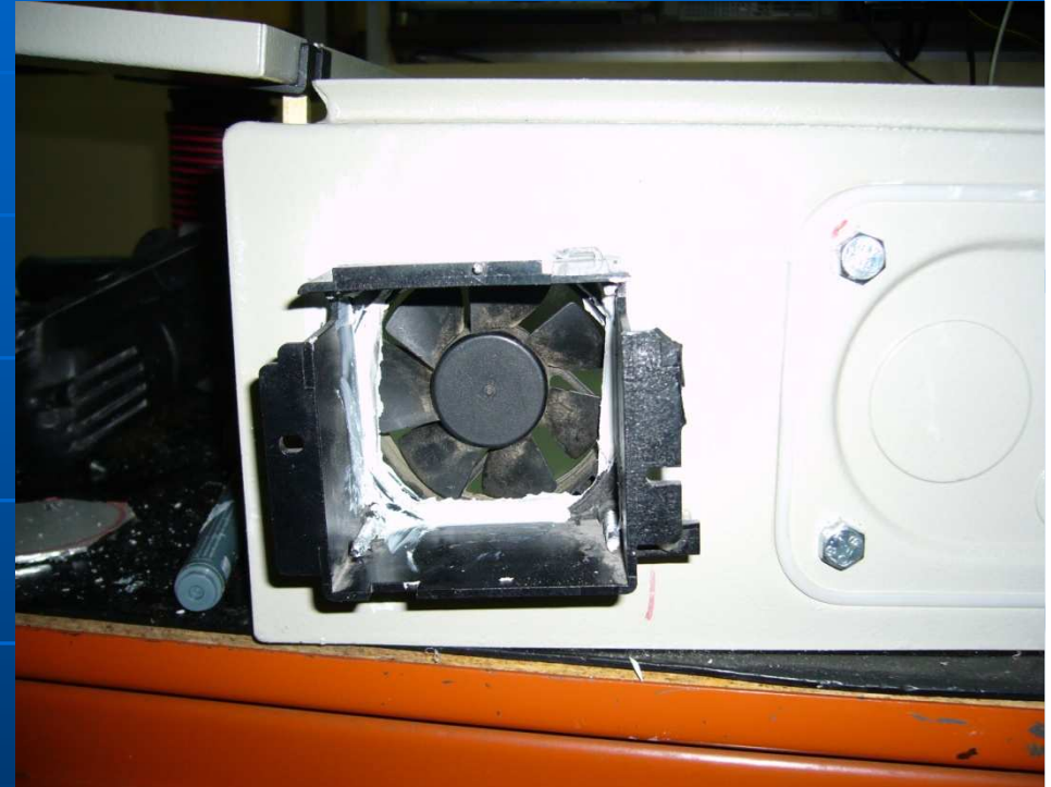
Τοποθέτηση ανεμιστήρα και βίδωμα
