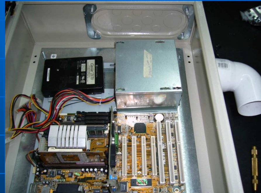
Πρόχειρη τοποθέτηση και σημάδεμα για τα τρυπήματα
