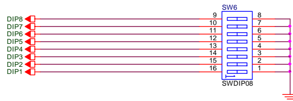
Σχήμα B.4.5.1 Κύκλωμα μικροδιακοπών (dip-switch)
