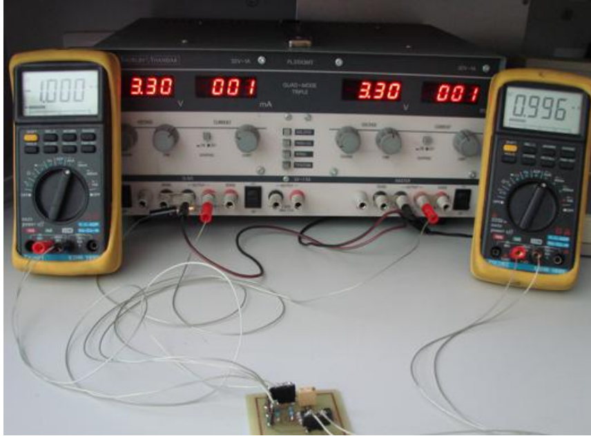
Σχ. 48 Το καθρέπτης Cascode σε λειτουργία
