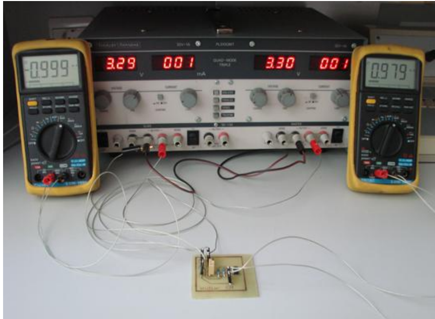
Σχ. 44 Το καθρέπτης Widlar σε λειτουργία
