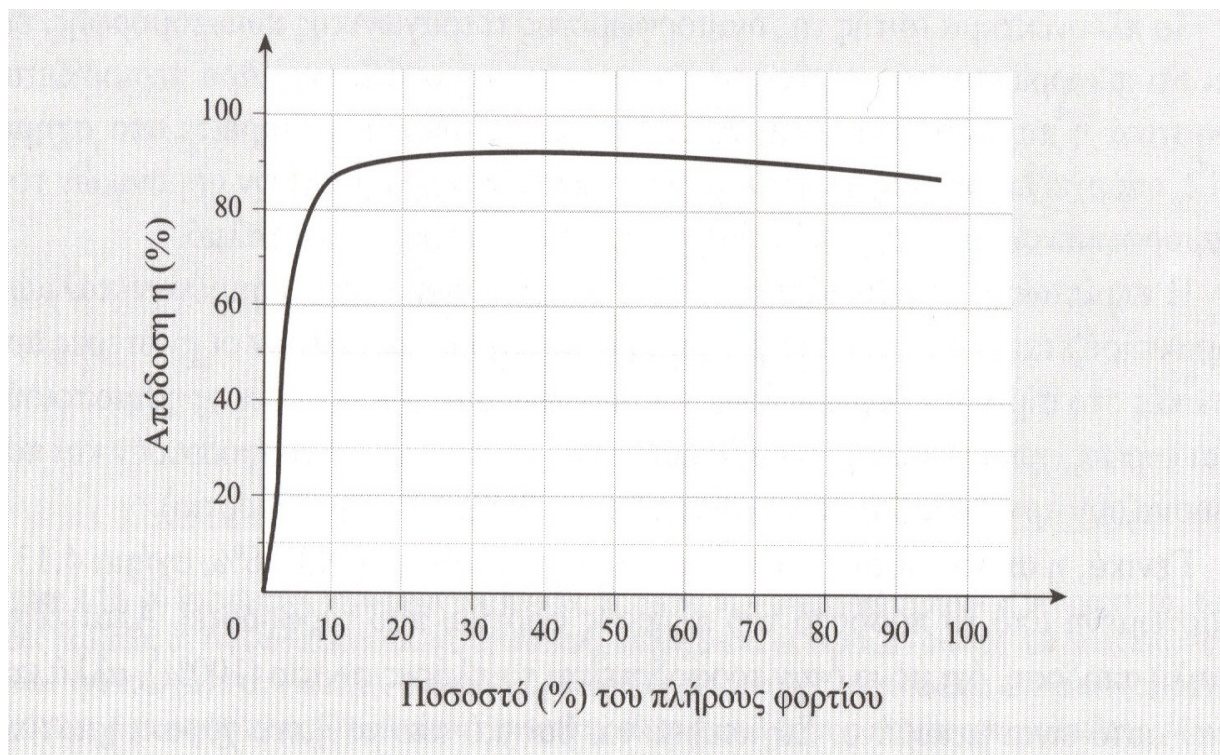
Σχήμα 3.4 Μεταβολή της απόδοσης του inverter σε συνάρτηση με το ποσοστό του πλήρους φορτίου που τροφοδοτεί
