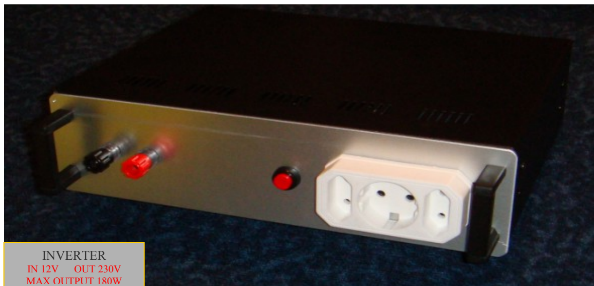
Εικόνα 4.9 Μετατροπέας τάσης από 12V DC σε 230V AC
