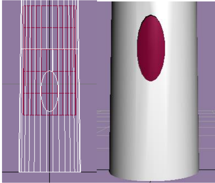
Σχ. 5.10 Αφαίρεση κυλίνδρου απ' το εσωτερικό του πύργου.
