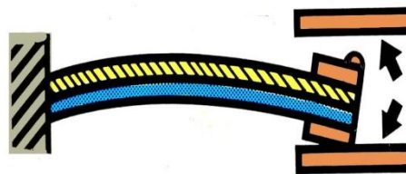
Σχήμα 2.3: Αισθητήριο με διμεταλλικό στοιχείο
