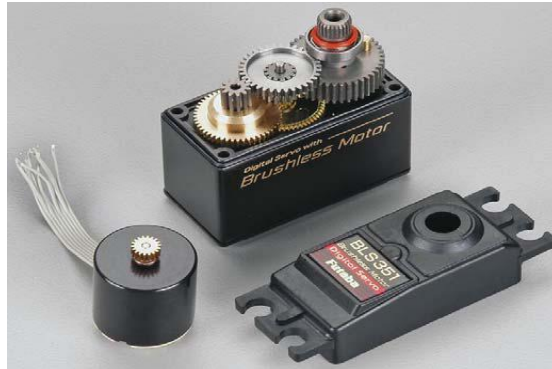
Σχήμα 3.13: Κιβώτιο υποβιβασμού της σχέσης μετάδοσης του κινητήρα.
