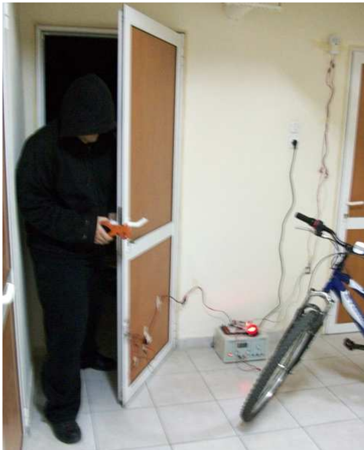
Σχήμα 4-40: Φύλαξη χώρου με εγκατάσταση του μαγνητικού διακόπτη στην πόρτα και του αισθητήρα κίνησης PIR
