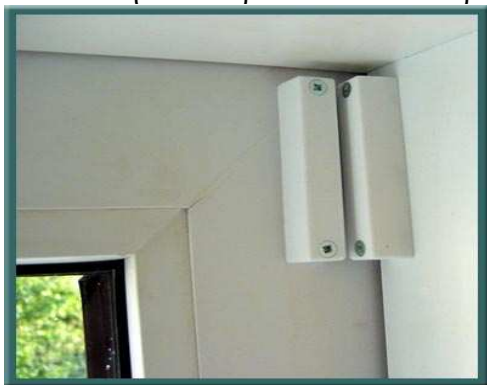
Σχήμα 3-2: Μαγνητικός ανιχνευτής σε παράθυρο
