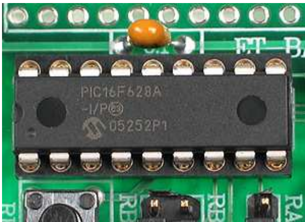
Σχήμα 2-5: Ο μικροελεγκτής PIC16F628A
