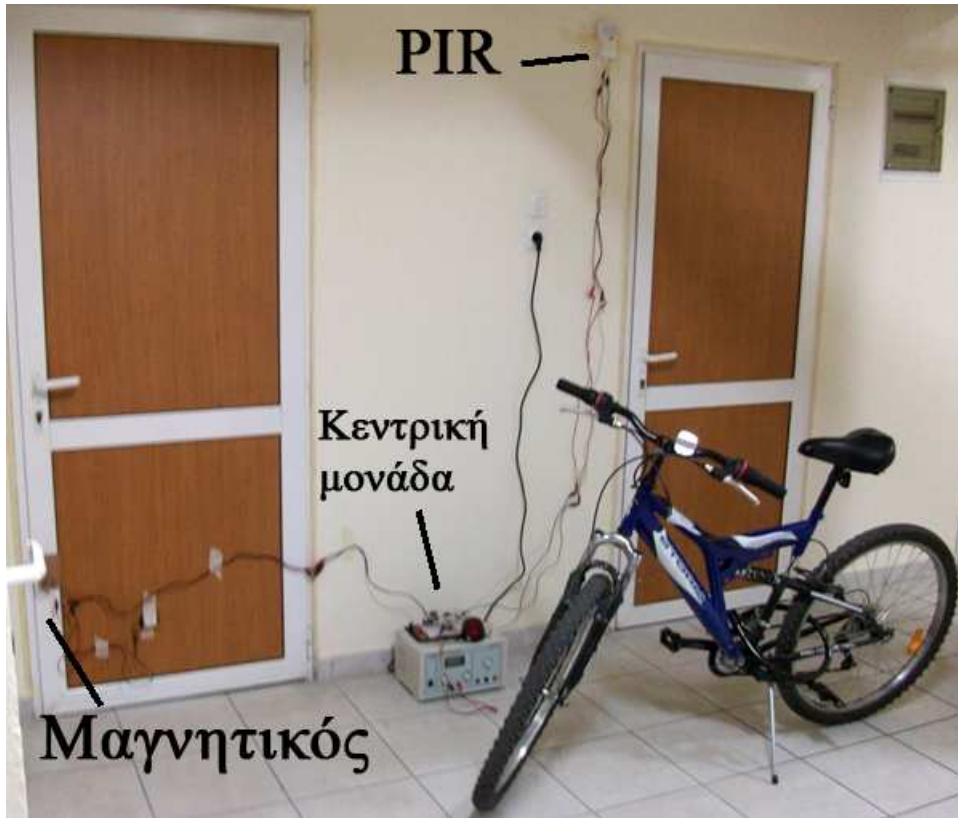
Σχήμα 4-40: Φύλαξη χώρου με εγκατάσταση του μαγνητικού διακόπτη στην πόρτα και του αισθητήρα κίνησης PIR
