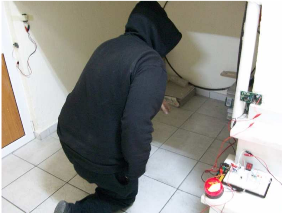
Σχήμα 4-37: Παραβίαση του χώρου, διακοπή της δέσμης υπερέθρων και ενεργοποίηση του συναγερμού
