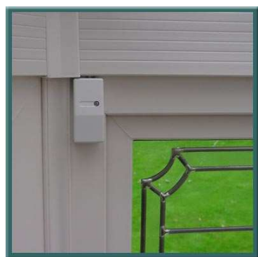
Σχήμα 3-6: Ανιχνευτής κραδασμών συναγερμός.
