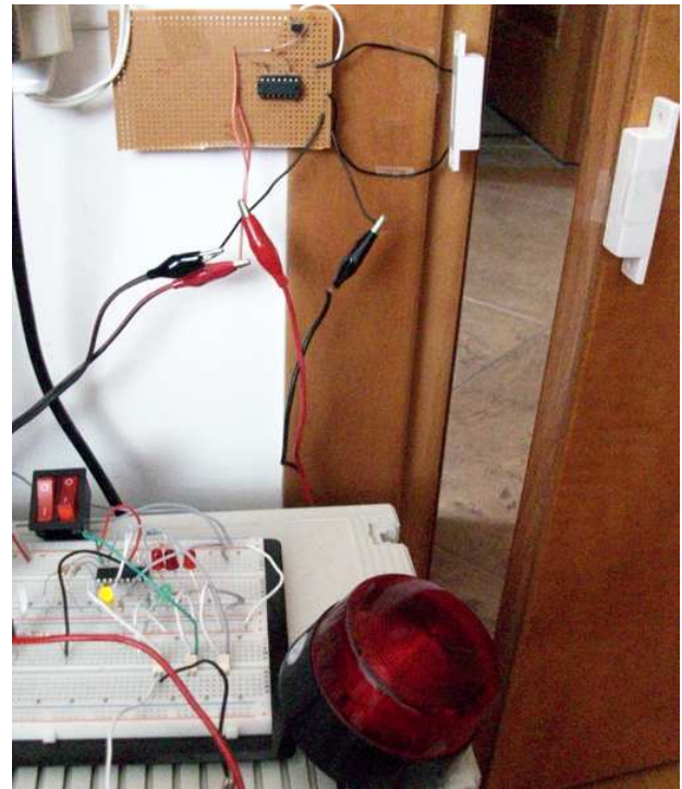
Σχήμα 4-33: Ανοίγοντας την πόρτα, ο συναγερμός δεν αντιδράει. Στην κατάσταση 'stand-by' μπορούμε να κάνουμε τις ρυθμίσεις που θέλουμε χωρίς να έχουμε ανεπιθύμητη ενεργοποίηση του συναγερμού
