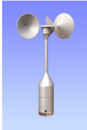
Εικόνα 2: Ο πιο συνηθισμένος τύπος ανεμομέτρου (Cup Anemometer)
