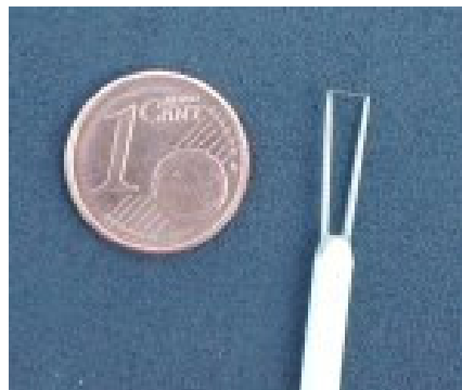
Εικόνα 4: Ανεμόμετρο τεχνολογίας θερμαινόμενου νήματος (Hot-Wire Anemometer)
