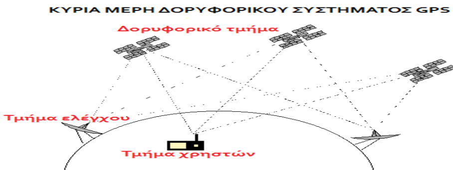
Σχ.5 Κύρια μέρη δορυφορικού συστήματος GPS.
