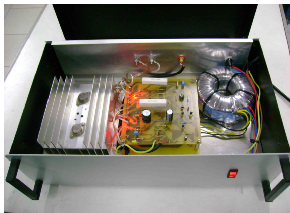
Προσαρμογή στο εσωτερικό του κουτιού και έλεγχος σωστής λειτουργίας.
