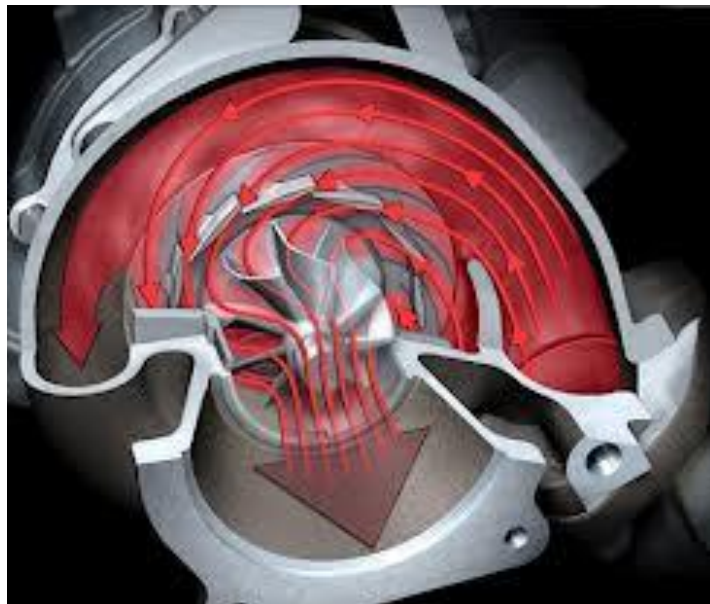
Σχήμα 3.35 Στρόβιλος μεταβλητής γεωμετρίας VGT
