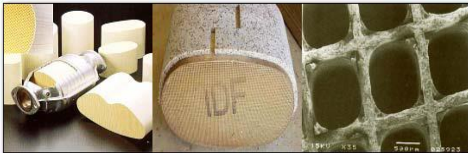
Σχήμα 3.8 Μορφή και τομή κεραμικού καταλύτη
