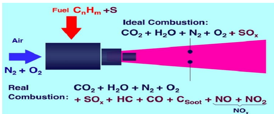
Σχήμα 2.9 Παραστατική μορφή της ιδανικής (ideal combustion) και της πραγματικής (real combustion) καύσης ενός καυσίμου
