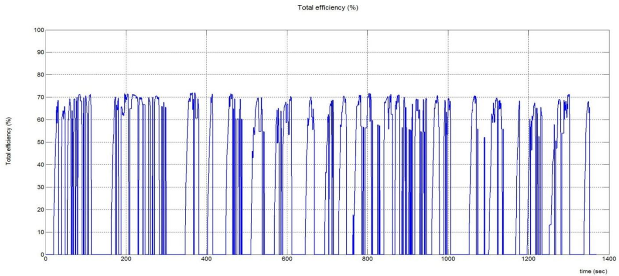
Εικόνα 5.51 Συνολικός βαθμός απόδοσης του DC ηλεκτροκινητήρα.
