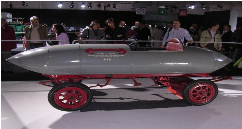
Εικόνα 1.3 Το " La Jamais Contente ". Το πρώτο όχημα που κατάφερε να φτάσει τα 100 km/h.
