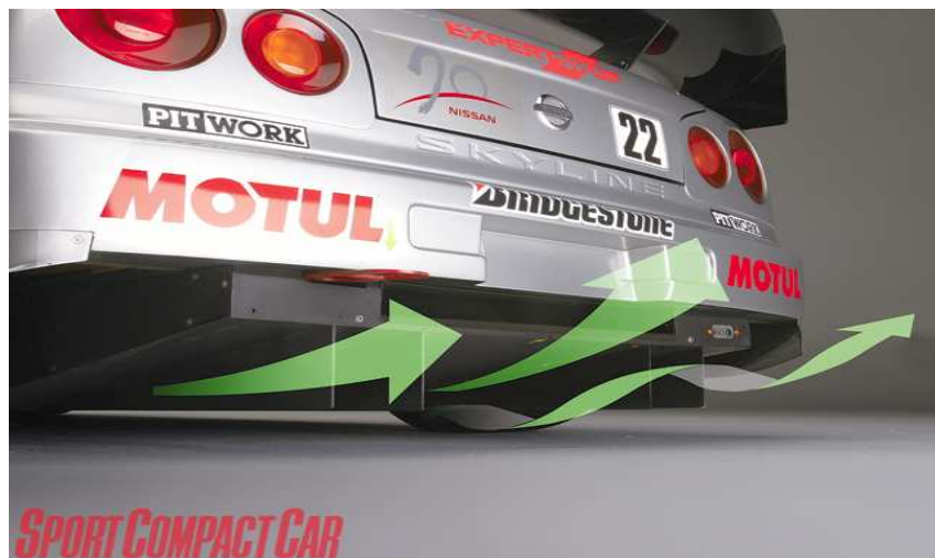
Σχήμα 1.3: Διαμόρφωση πατώματος αυτοκινήτου παραγωγής της σύγχρονης εποχής, αγωνιστικής μόνο χρήσης.
