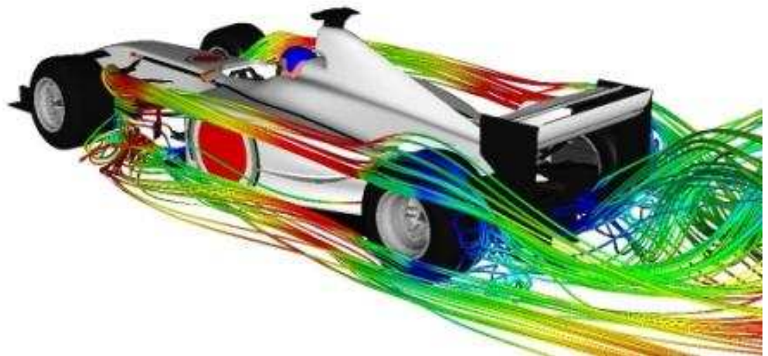
Σχήμα 4.9: Γραφική απεικόνιση των στροβιλισμών που προκαλεί ένας διαχύτης στην ροή του ρεύματος αέρα που εξέρχεται από αυτόν.
