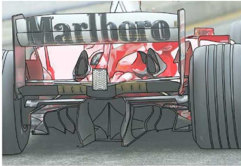
Σχήμα 4.3: Οπίσθια άποψη της Ferrari F2004, που επεξηγεί τα σύνθετα σχέδια στους πλευρικούς και κεντρικούς πολυκάναλους διαχύτες. Διακρίνονται τα κυρτά κάθετα πτερύγια των πλευρικών διαχυτών.
