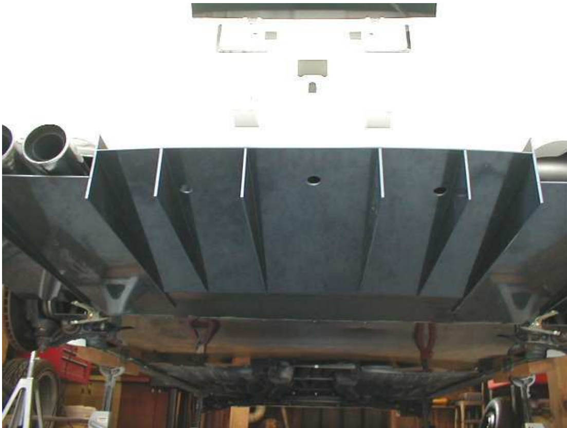
Σχήμα 6.6: Πρόσθετος διαχύτης σε αυτοκίνητο με εμφανή τα κανάλια του διαχύτη.
