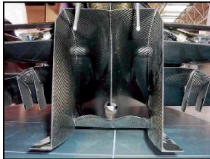
Σχήμα 3.3: Τυπικός διαχύτης σε μονοθεσίου της F1.
