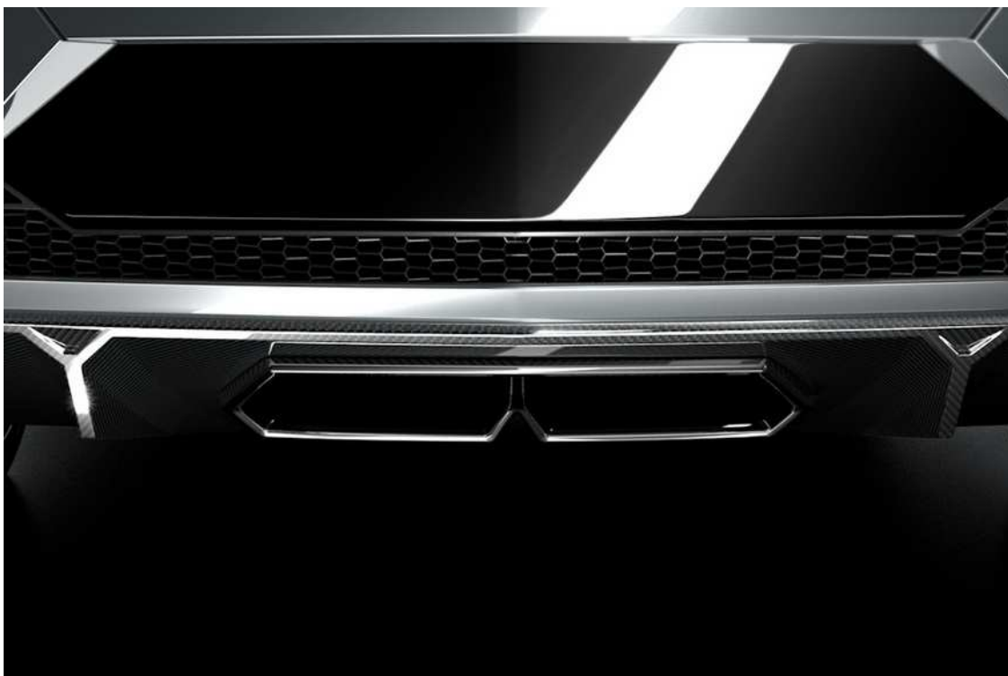
Σχήμα 6.4: Πρόοψη απόληξης διαχύτη από Lamborghini Murcielago Reventon.
