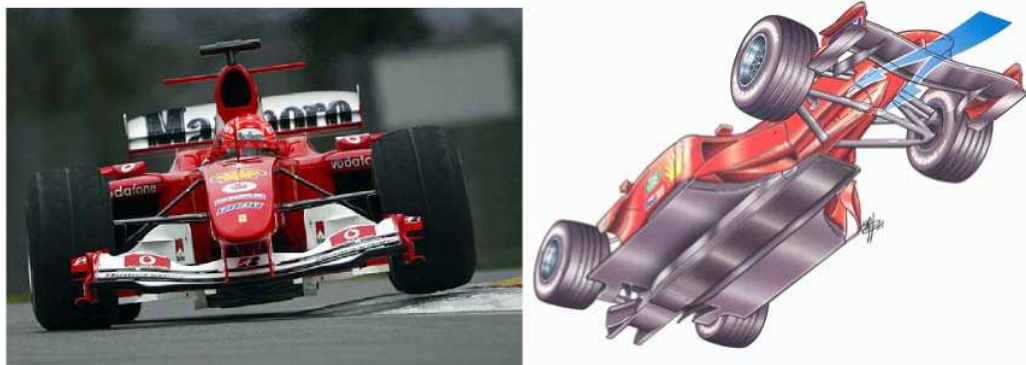
Σχήμα 1.2: Βαθμιδωτό πάτωμα σημερινού μονοθεσίου της Φόρμουλα 1.
