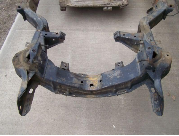
Σχήμα 12. Βάση από λαμαρίνα (48 κομμάτια και 28kg)
