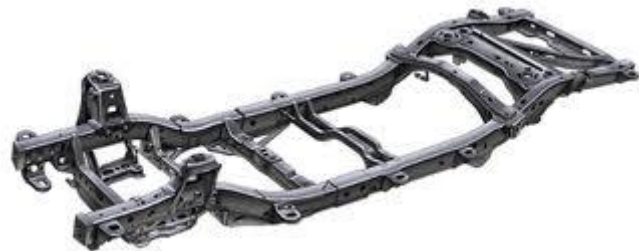
Σχήμα 31. Υδροδιαμορφωμένο πλαίσιο του SSR από χάλυβα.
