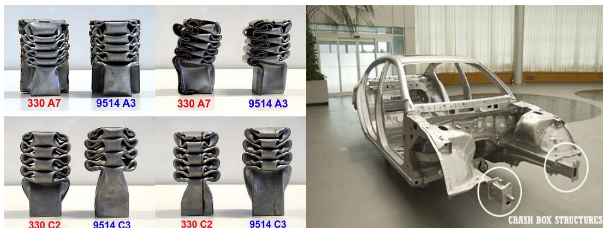
Σχήμα 6. Ένα από τα συστήματα απορρόφησης ενέργειας τα Crash Box.
