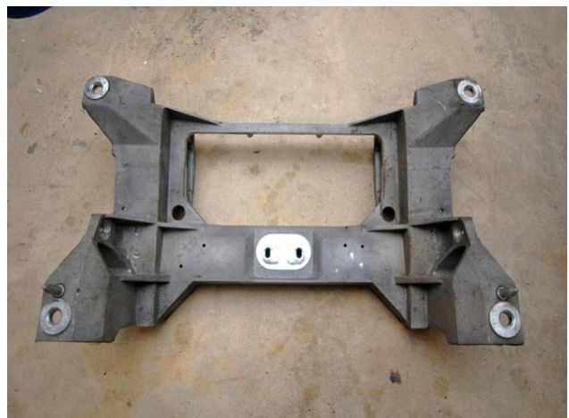
Σχήμα 15. Βάση κινητήρα από μαγνήσιο (1 κομμάτι/10kg)
