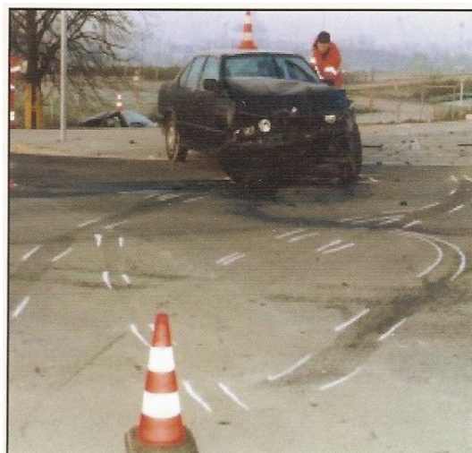
Ίχνη τροχών με υπέρβαση συντελεστού τριβής (με εκτροπή/εγκάρσια ολίσθηση – τα ίχνη των τροχών τέμνονται)
