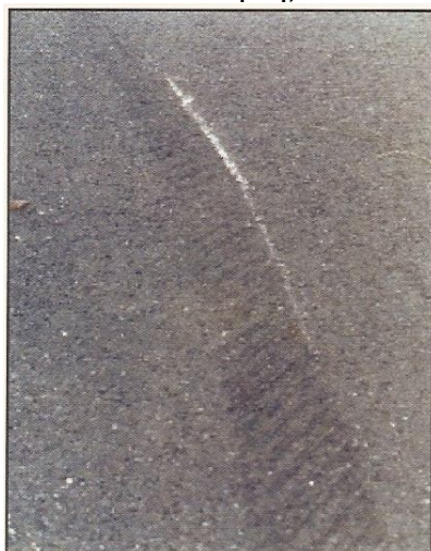
Ίχνη τροχών στο όριο υπέρβασης συντελεστού τριβής (χωρίς εκτροπή/εγκάρσια ολίσθηση – τα ίχνη των τροχών δεν τέμνονται)
