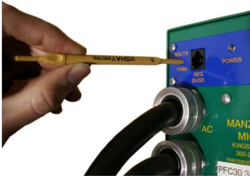
Σχήμα 4-15 Ειδικό εργαλείο ρύθμισης ποτενσιόμετρου τάσης.
