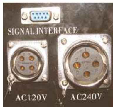
Σχήμα 4-23 Ακροδέκτες εισόδου και θύρα σύνδεσης με BMS.
