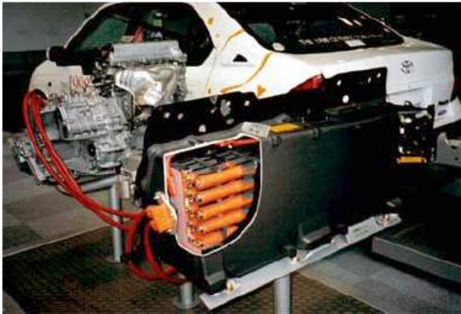
Σχήμα. 3-11 Συστοιχία μπαταριών NiMH ενός ηλεκτρικού οχήματος.
