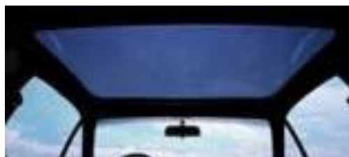
Ηλεκτροχρωμική ηλιοροφή στο καθαρό στάδιο
