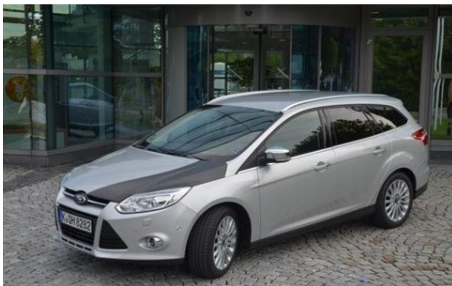
Σχήμα 3.9: Καπό από ανθρακονήματα σε πρωτότυπο Ford Focus ΚΑΠΟ ΣΕ PEUGEOT 106 RALLYE
