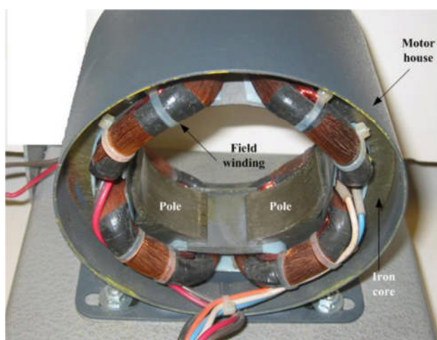
Σχήμα 3.2.β-Στατης κινητήρα DC
