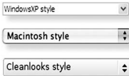
Εικόνα 3.2.1β: Εμφάνιση των Qt κουμπιών σε διαφορετικές πλατφόρμες
