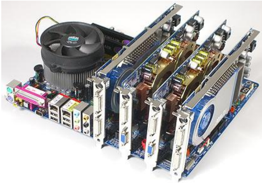
Σχήμα 3.3.2 : Πολλαπλές κάρτες γραφικών συνδεδεμένες σε μία μητρική κάρτα
