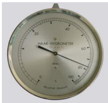
ΣΧΗΜΑ 44: ΥΓΡΟΜΕΤΡΟ ΤΡΙΧΑΣ (ΑΠΟ HTTP://EL.WIKIPEDIA.ORG )
