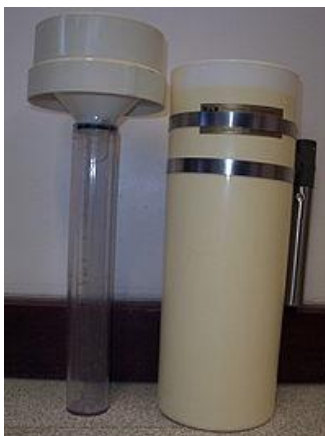
ΣΧΗΜΑ 40: ΒΡΟΧΟΜΕΤΡΟ (ΑΠΟ HTTP://EL.WIKIPEDIA.ORG )
