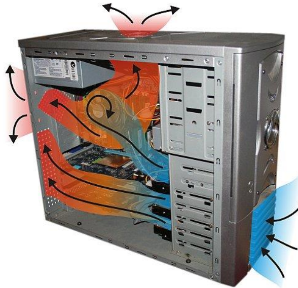
Εικόνα 2.15: Μια τυπική διαδρομή του αέρα μέσα από το κουτί
