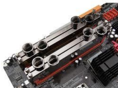
Εικόνα 4.19 : Μπλόκ υδρόψυξης σε τροφοδοτικό (εσωτερικά του κουτιού ) και στις μνήμες Ram.
