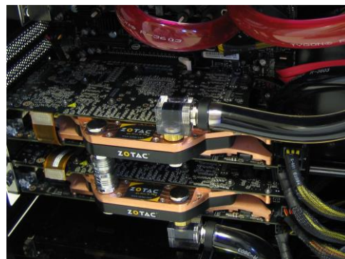
Εικόνα 4.16 : Παραδείγματα full cover μπλόκ κάρτας γραφικών. Εφαρμογή σε όλη τη πλακέτα. Ψύχει το κεντρικό τσιπ της vga, αλλά και τις μνήμες ram της vga.
