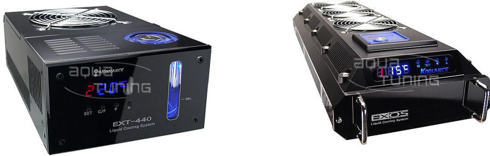
Εικόνα 4.1 : Εξωτερικά κιτ υδρόψυξης της εταιρείας Koolance.
