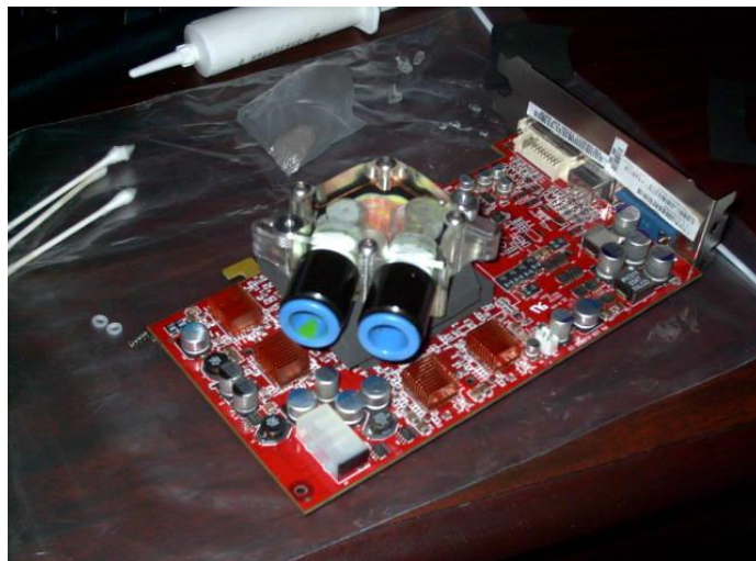
Εικόνα 3.7 :Εγκατεστημένο και το μπλόκ της υδρόψυξης. Κάτω από το μπλόκ βρίσκεται το peltier.
