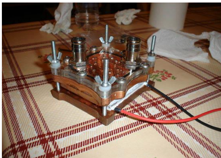
Εικόνα 3.9 :Χρήση χαλκού ανάμεσα στο peltier και την cpu.
