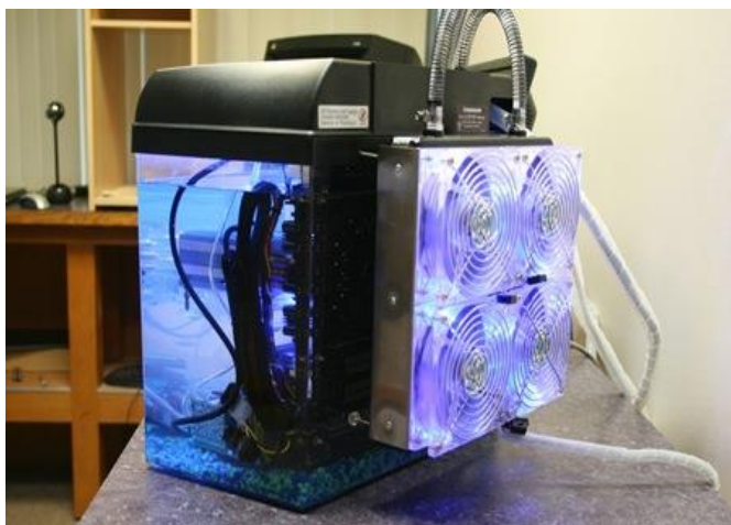
Εικόνα 5.3 : Χρήση ψυγείου με ανεμιστήρες για πιο άμεση ψύξη λαδιού. Χάνουμε βέβαια το προνόμιο της 100% αθόρυβης ψύξης
