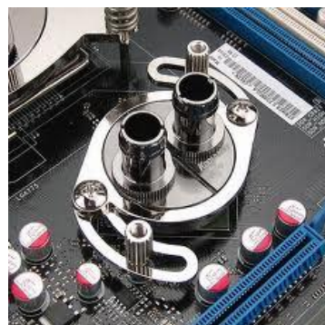
Εικόνα 4.18 :Μπλόκ υδρόψυξης σε Northbridge και Southbridge.
