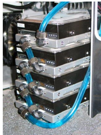
Εικόνα 4.17 :Μπλόκ υδρόψυξης σε σκληρό δίσκο
