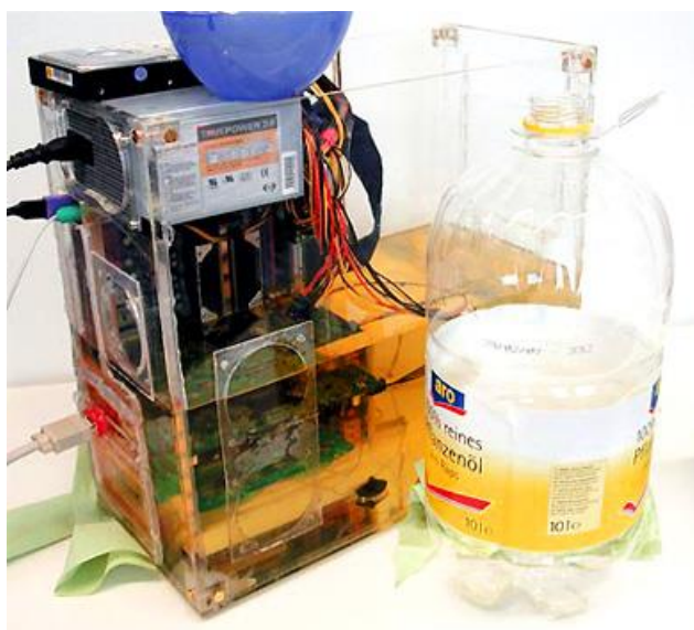
Εικόνα 5.2 : Υλοποίηση oil pc με vegetable oil
