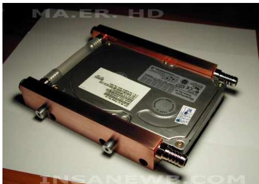
Εικόνα 4.17 :Μπλόκ υδρόψυξης σε σκληρό δίσκο
