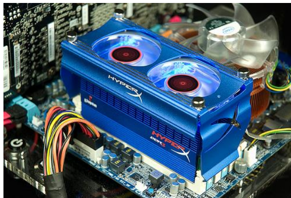
Εικόνα 2.13 : Ανεμιστήρας για την ψύξη μνημών RAM
