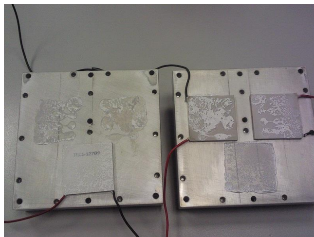
Εικόνα 3.11 :Peltier ανάμεσα σε χειροποίητο μπλόκ υδρόψυξης.
