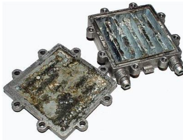
Εικόνα 4.24 : Διαβρωμένο μπλόκ απο άλατα, λόγω χρήσης μη απεσταγμένου-απιονισμένου νερού.
