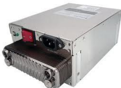
Εικόνα 4.19 : Μπλόκ υδρόψυξης σε τροφοδοτικό (εσωτερικά του κουτιού ) και στις μνήμες Ram.
