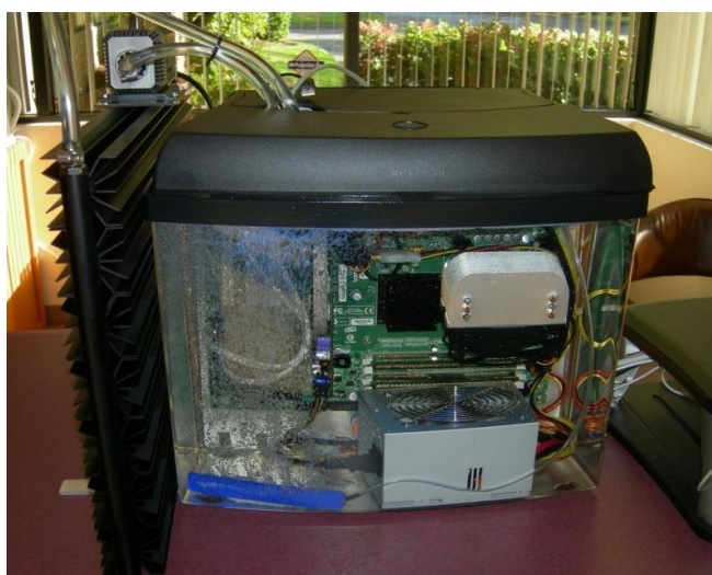
Εικόνα 5.4 : Χρήση ψυγείου, αλλά χωρίς ανεμιστήρες.
