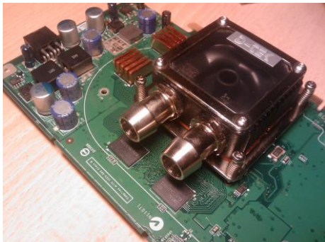
Εικόνα 4.15 : Παραδείγματα μπλόκ κάρτας γραφικών. Εφαρμογή μόνο στο κεντρικό τσιπ της vga.
