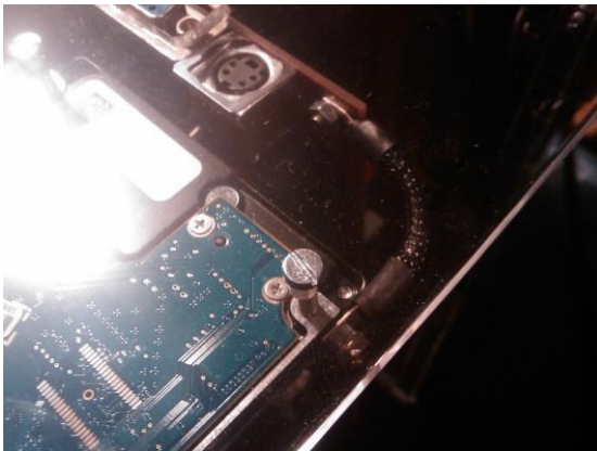
Εικόνα 5.7 : Γείωση και στη κάρτα γραφικών.
