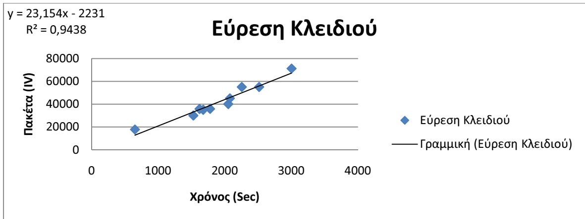
Σχήμα 5.3 Διάγραμμα διασποράς των ληφθέντων IV πακέτων σε σχέση με το χρόνο στην επίθεση Arp Request Replay με χρήση της μεθόδου KoreK στο σενάριο 1
