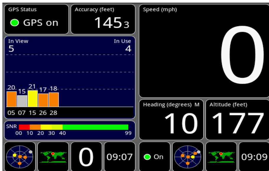
Εικόνα 7. Οθόνη GPS εφαρμογής για κινητά Android που παρουσιάζει πληροφορίες που λαμβάνει από τους δορυφόρους.
