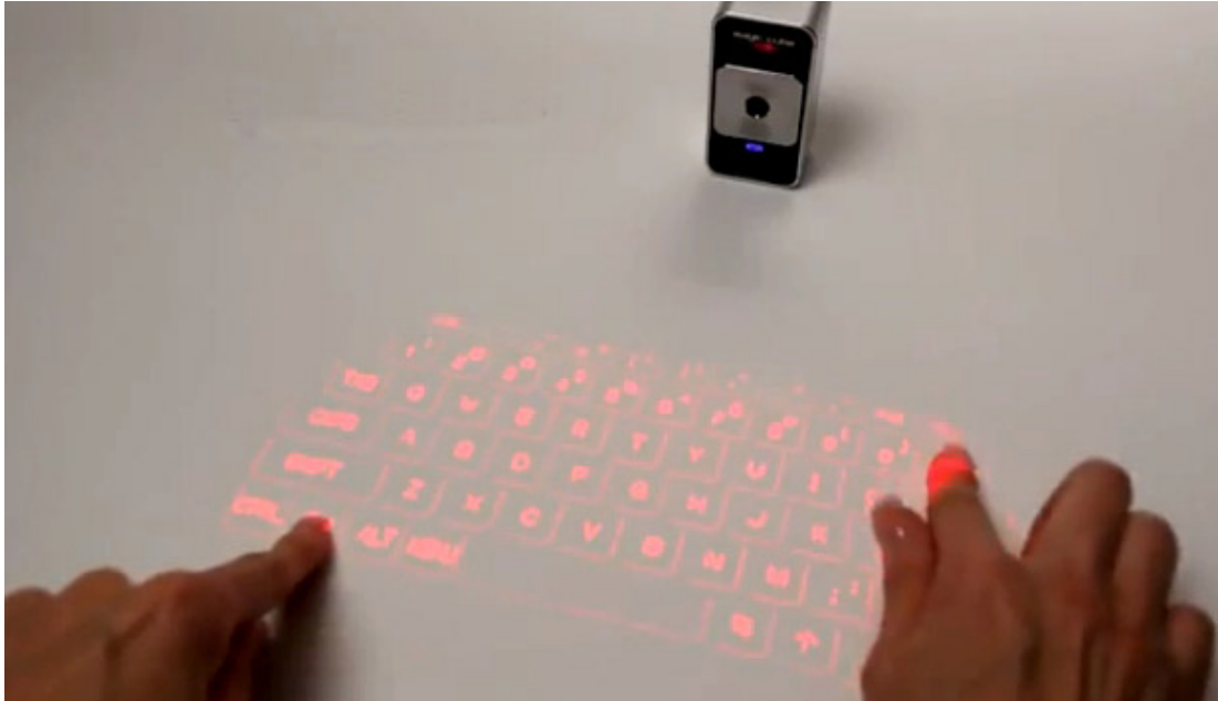
Εικόνα 4. Προβολική συσκευή που δημιουργεί ένα εικονικό πληκτρολόγιο.
