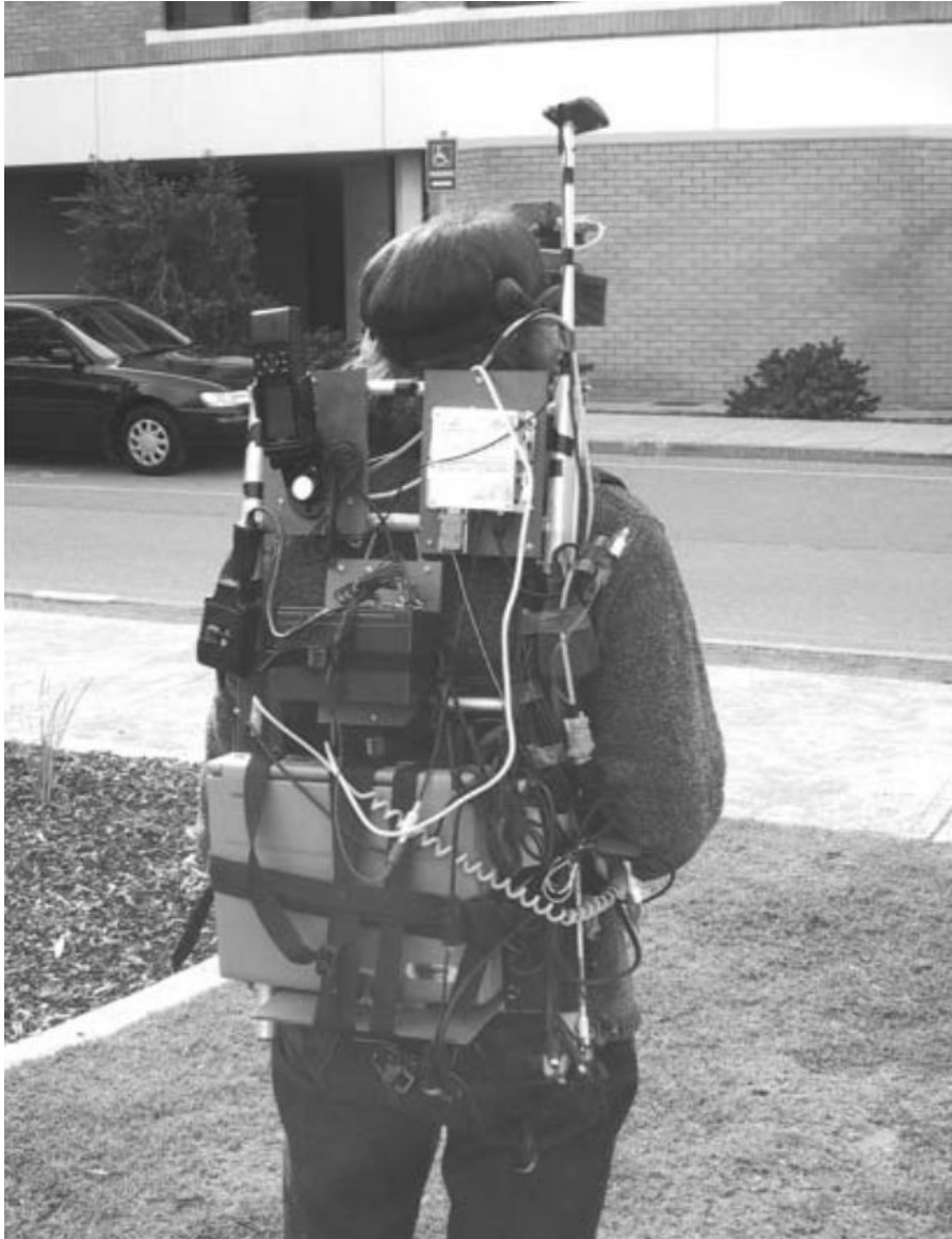
Εικόνα 24. Εξοπλισμός που απαιτούνταν για το ARQuake.
