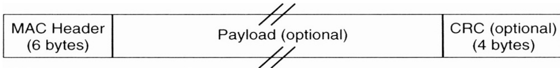
Σχήμα 4.14 Γενική μορφή ενός MAC frame ή MAC PDU [4]
