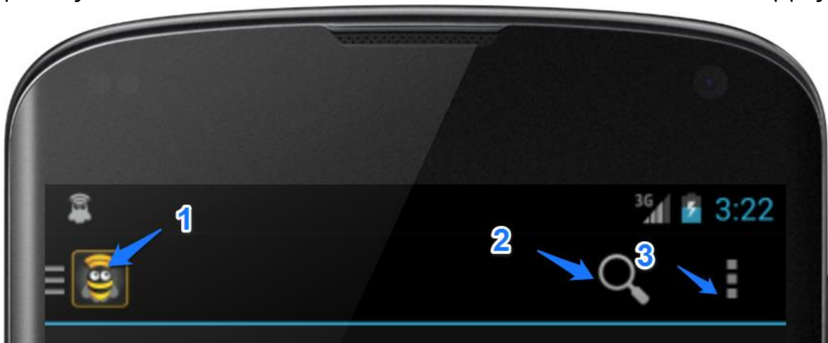
Εικόνα 3. ActionBar η οποία περιέχει [1] το εικονίδιο της εφαρμογής, [2] ένα action item, και [3] το κουμπί υπερχειλίσης (overflow button)
