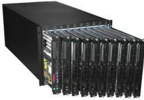
Εικόνα 3.2 Εξυπηρετητής blade (“8U Rack amount Blade Server Chassis”)
