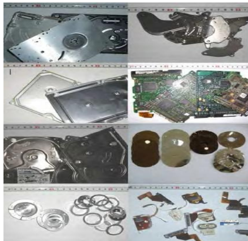
Εικόνα 3.1 Αποσυναρμολόγηση και Συλλογή Υλικών προς Αποκατάσταση
