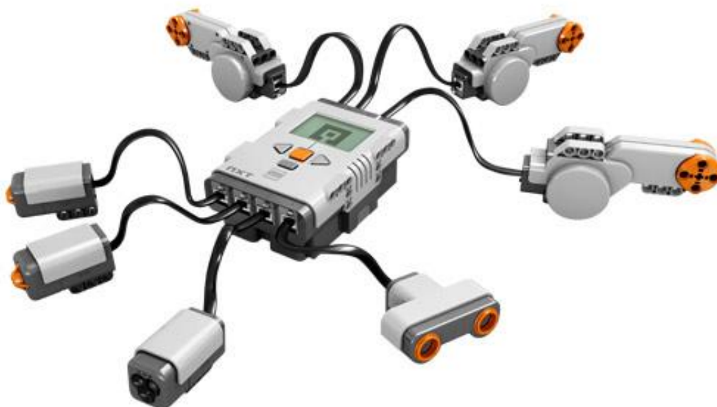
Εικόνα 12 "Το NXT τούβλο - Στη μέση της εικόνας απεικονίζεται το NXT τούβλο, επάνω οι τρεις κινητήρες και κάτω με σειρά από αριστερά προς τα δεξιά οι δύο αισθητήρες επαφής, ο αισθητήρας χρώματος και ο αισθητήρας υπερήχων"
