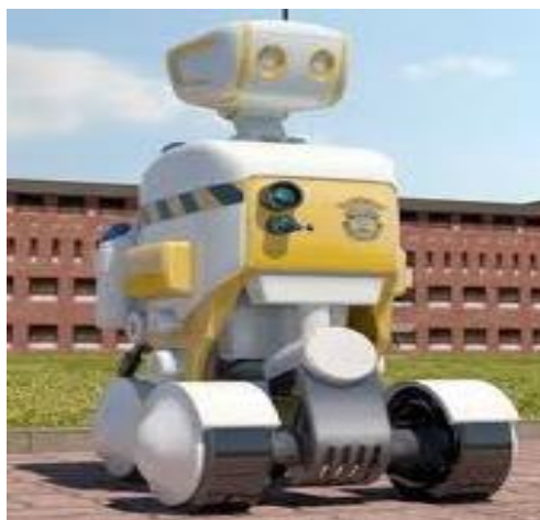
Εικόνα 5 "Έντροχο ρομπότ - Το συγκεκριμένο έχει τρεις τροχούς, ένα πίσω και δύο μπροστά και μπορεί να κινείται σε ευθεία και να στρίβει"
