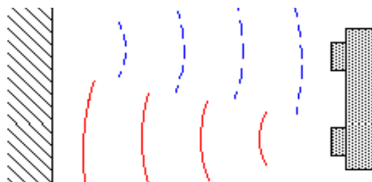
Εικόνα 14 "Τρόπος λειτουργίας αισθητήρα υπερήχων - Ένα κύμα στέλνεται από τον πομπό (βλέπε κόκκινο χρώμα) και λαμβάνεται από το δέκτη (βλέπε μπλε χρώμα) "
