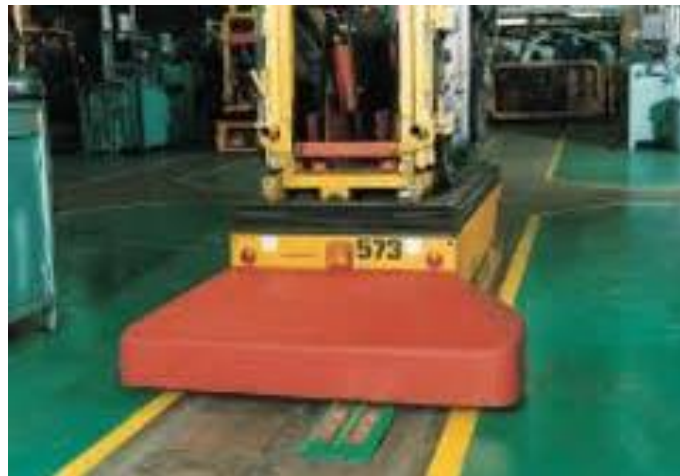
Εικόνα 4 "Αυτόματα κατευθυνόμενο όχημα - Το εικονιζόμενο όχημα κινείται διαβάζοντας τις κίτρινες γραμμές που υπάρχουν στο πάτωμα "
