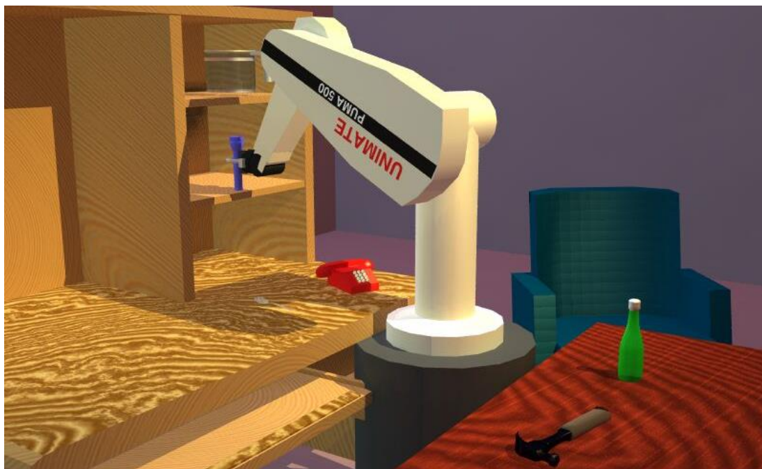
Εικόνα 3 "Ρομποτικός βραχίονας PUMA - Ένα από τα πιο χαρακτηριστικά παραδείγματα του είδους του. Ο τρόπος με τον οποίο είναι σχεδιασμένο του επιτρέπει να κινηθεί προς όλες τις κατευθύνσεις και είναι σε θέση να φτάσει και να μετακινήσει όλα τα αντικείμενα που φαίνονται στην εικόνα"
