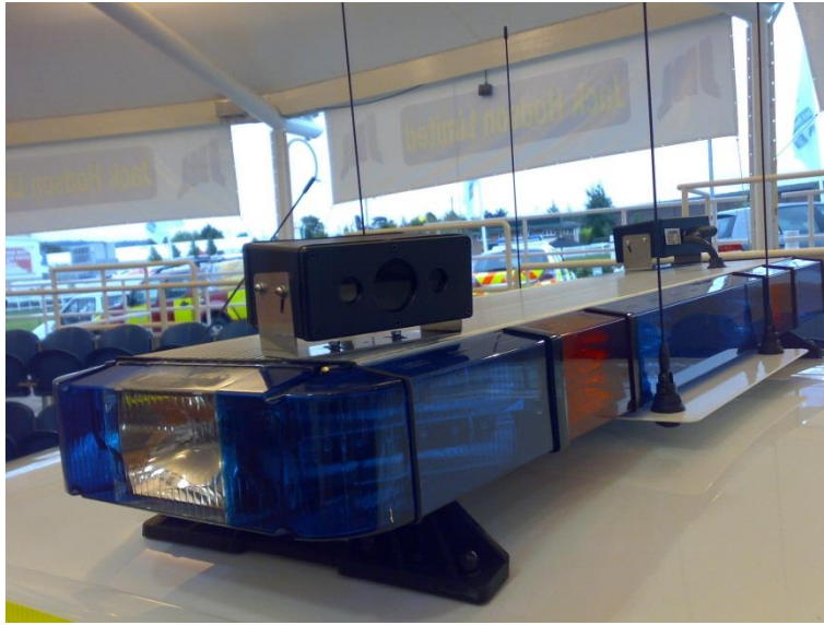
Κάμερα συστήματος αυτόματης αναγνώρισης πινακίδων κυκλοφορίας ενσωματωμένη σε περιπολικό
