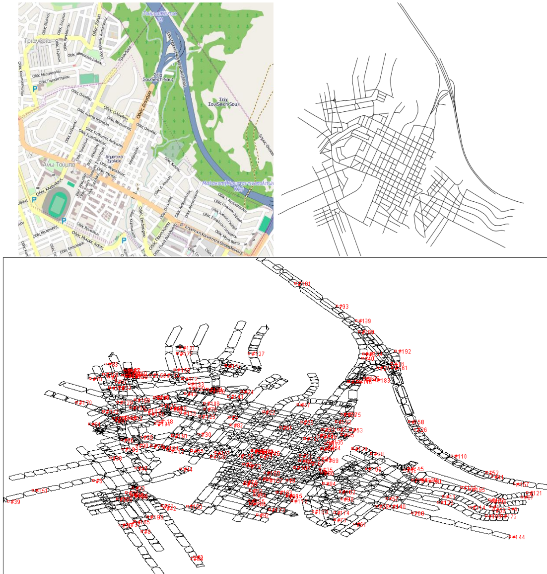
Σχήμα 19 – Παράδειγμα μετατροπής του χάρτη σε .xmi αρχείο με στόχο να χρησιμοποιηθεί από το VanetMobisim.
