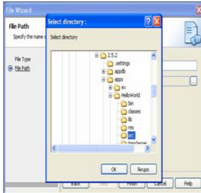
Εικόνα 12: Αποθήκευση του java αρχείου στον src φάκελο του project
