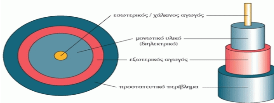
Εικόνα 4: Η δομή του ομοαξονικού καλωδίου
