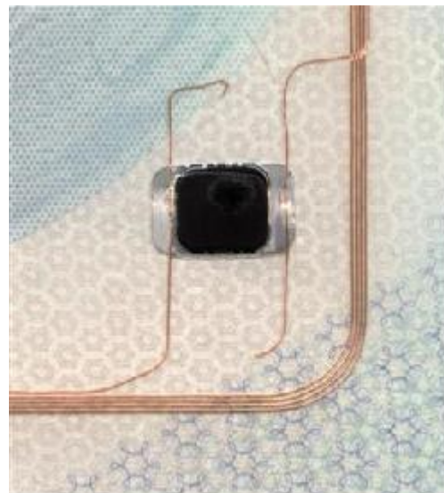
Σχήμα 15. RFID chip ενσωματωμένο σε e - passport
