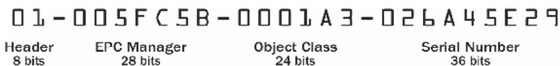
Σχήμα 1. Παράδειγμα 96-bit EPC
