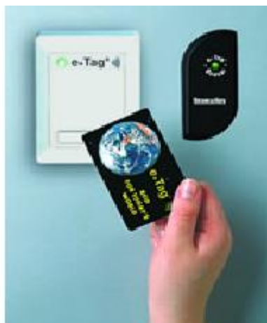
Σχήμα 11. Ειδική κάρτα και αναγνώστης RFID για έλεγχο πρόσβασης
