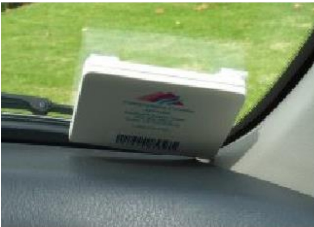
Σχήμα 12. Ενεργή ετικέτα για πληρωμή διοδίων
