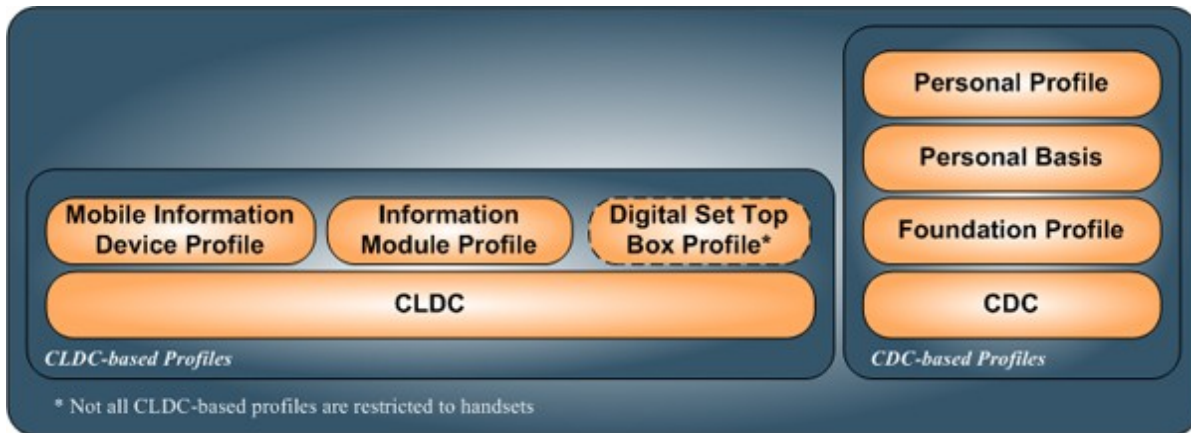
Εικόνα 4.1 - Τα Configurations και Profiles της J2ME platform
