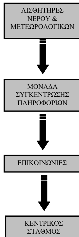
Εικόνα 4: Διάγραμμα ροής δεδομένων του συστήματος Ανδρομέδα
