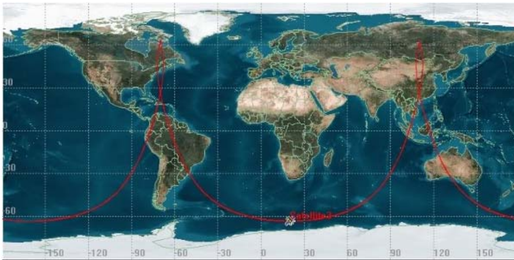
Εικόνα 2-19 Παράδειγμα τροχιάς τύπου MOLNYA
