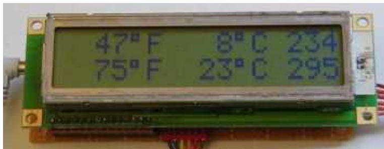
ΕΙΚΟΝΑ I: ΔΙΠΛΟ ΘΕΡΜΟΜΕΤΡΟ ΜΕ ΣΕΙΡΙΑΚΗ ΕΞΟΔΟ PIC16F876
