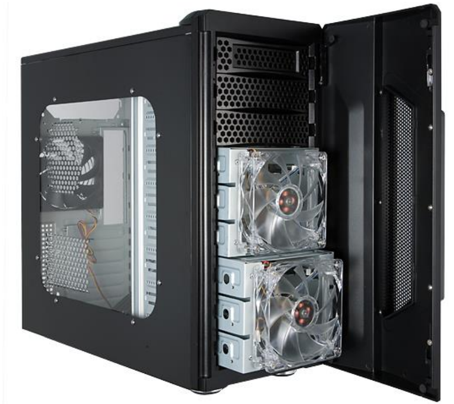
Εικόνα 4.3-1 Θήκη με διπλούς ανεμιστήρες σε κάθε πλευρά για τη δημιουργία ροής αέρα
