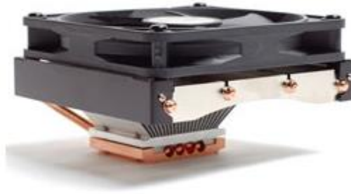
Εικόνα 4-1 Ψήκτρα με χάλκινη βάση και αλουμινένια πτερύγια
