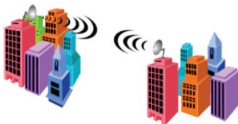
Σχήμα 3.4: Point to point σύνδεση
