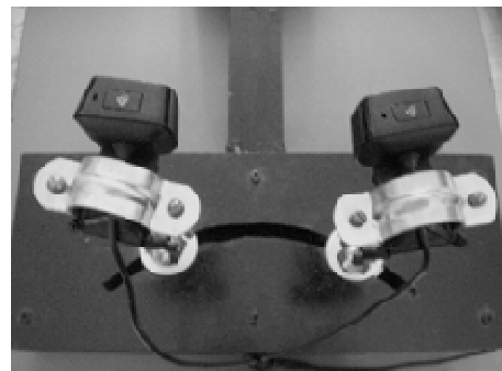
6-18: Λεπτομέρεια στήριξης καμερών στην σκηνή φωτογράφισης του Horasis
