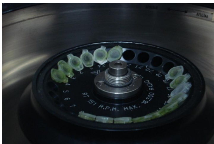
Εικόνα 26: Τοποθετημένα επερντόφ μέσα στην φυγόκεντρο.
