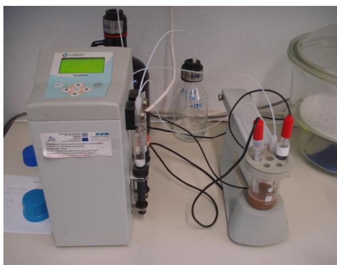
Εικόνα 24: Μηχάνημα που μας δείχνει αρχικό τελικό pH και πόσο υδροξείδιο του νατρίου χρειάστηκε.
