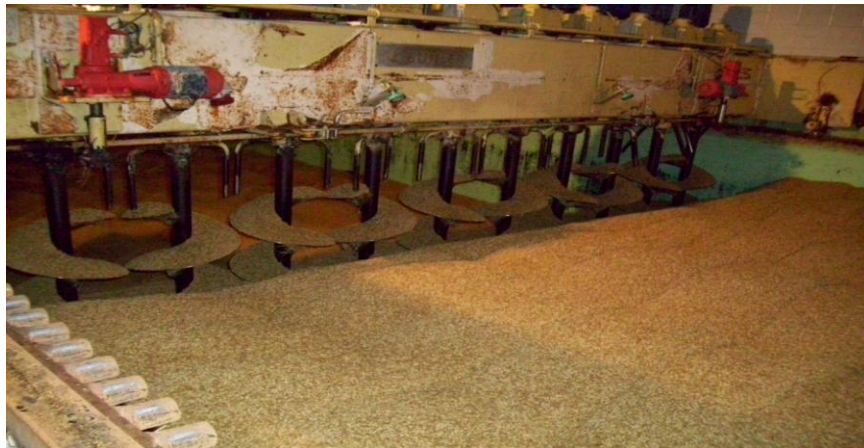
Εικόνα 8: Ξήρανση σπόρων κριθαριού σε ειδικούς χώρους.(Πηγή: I.M.)
