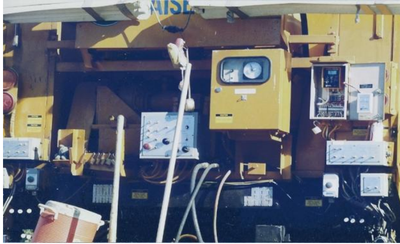
Εικόνα 54: Μεταρρυθμιστής / Μονάδα ελέγχου οδοστρώσις
