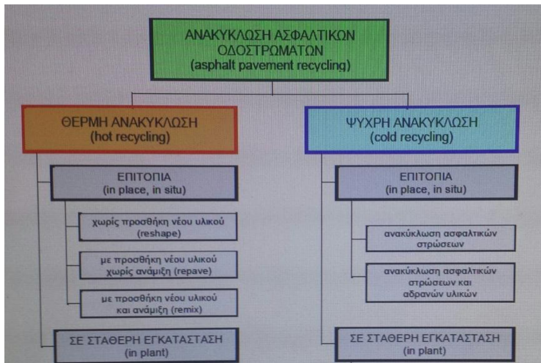
Εικόνα 20: Μορφές ανακύκλωσης ασφαλτικών οδοστρωμάτων
