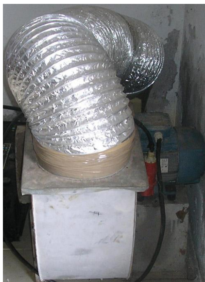
Σχ. 3.13.: Φορητός φυσητήρας για αερισμό κλειστών χώρων.
