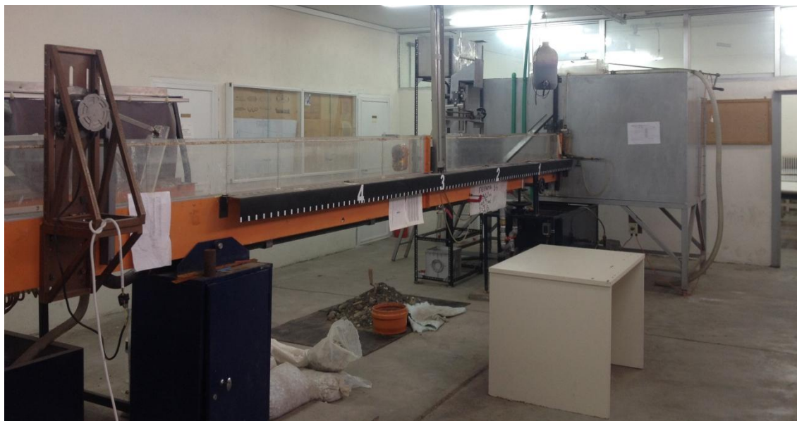
Εικόνα 3.2 :Γενική άποψη του καναλιού. Στα αριστερά βρίσκεται η διάταξη της κυματογεννήτριας και στο δεξί απέναντι άκρο του καναλιού φαίνεται το plexi glass του πρανούς.
