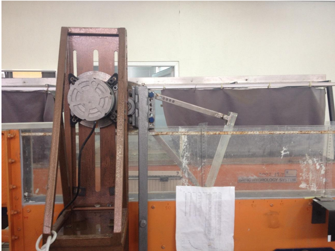
Εικόνα 3.3: Διάταξη της κυματογεννήτριας: Κουπί από διαφανές plexi glass, μεταλλικός βραχίονας και περιστροφικός μηχανισμός.
