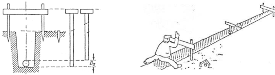
Σχήμα 1. Έλεγχος βάθους τοποθέτησης σωλήνων
