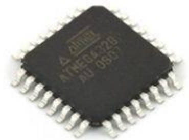
Σχήμα 3.1 Μικροελεγκτής ATMEGA 328 Χρησιμοποιείται ως CPU στον arduino
