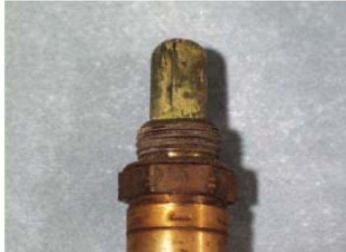
Εικόνα 27: Επαφή αισθητήρα με ψυκτικό υγρό. (ΠΗΓΗ: www.boschautoparts.com )
