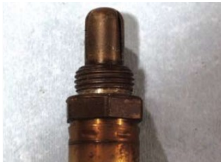
Εικόνα 28: Επαφή αισθητήρα με λάδια κινητήρα. (ΠΗΓΗ: www.boschautoparts.com )
