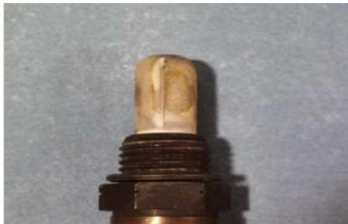
Εικόνα 26: Αισθητήρας εκτεθειμένος για πολύ χρόνο με πλούσιο μείγμα(ΠΗΓΗ: www.boschautoparts.com )
